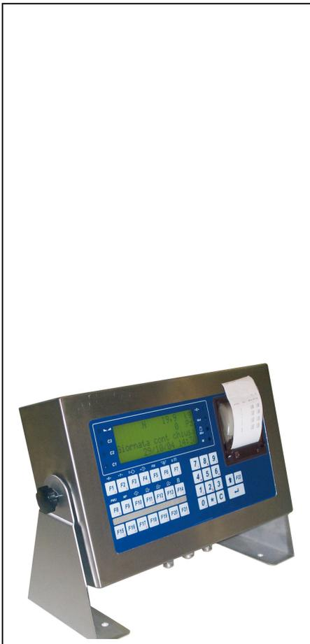
Indicatore elettronico per applicazioni su piattaforme e sistemi di pesatura fino a 8 celle di carico da 350  $\Omega$ . Il terminale è dotato di Certificato di Approvazione CE del tipo in conformità ai requisiti della norma EN 45501 e della guida Welmec2.1 per essere utilizzati quale modulo in applicazione ai sistemi di pesatura con altri componenti omologati.
