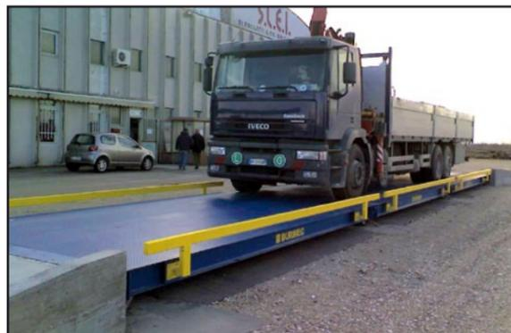
Pesa a ponte serie **M/E**, tipo modulare che permette l'allungamento futuro della piattaforma mediante l'aggiunta di ulteriori moduli.
